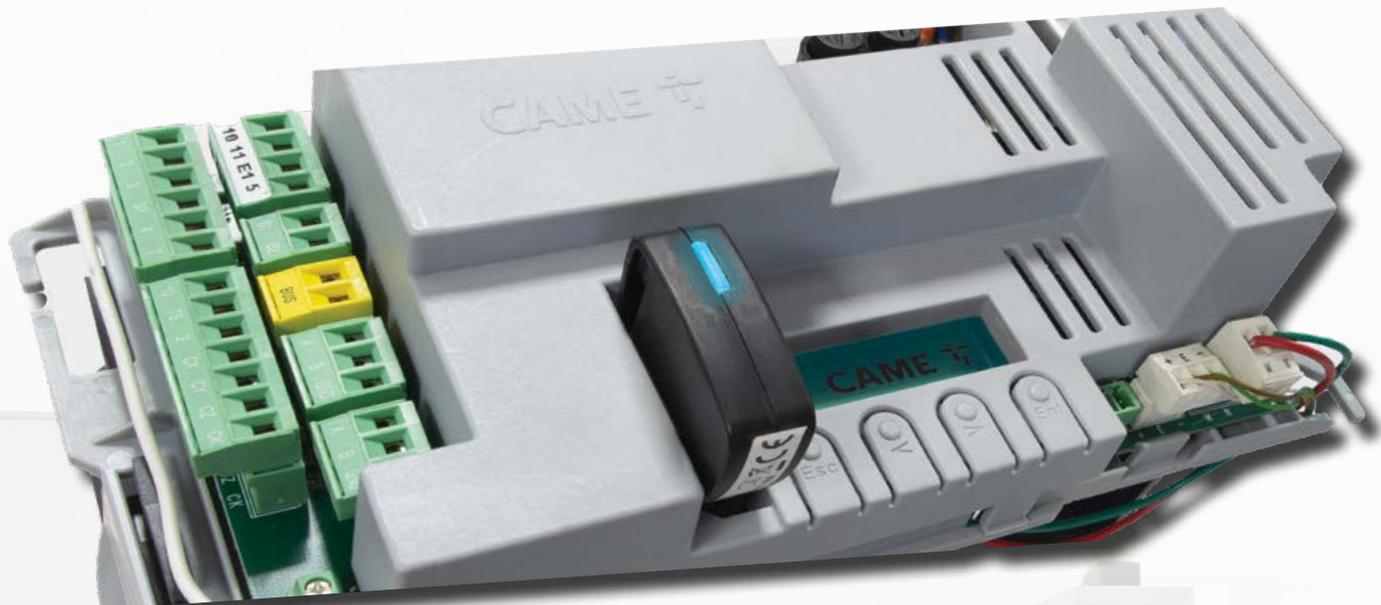
De cette manière, le pilotage garantit que les vantaux du portail s'ouvrent et se ferment toujours à la même vitesse, même dans des conditions météorologiques différentes, ou si les conditions environnementales changent au fil du temps. » En outre, le pilotage a une vitesse réduite lors de l'ouverture et de la fermeture. « Cela permet d'économiser la motorisation et d'être silencieux. »
