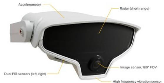
**OTTAWA, Canada** – Le fabricant de capteurs Senstar commercialise un nouveau système de détection, le MultiSensor. Il est équipé d'un radar, d'une caméra, d'un capteur de vibrations, de détecteurs à infrarouge et d'un accéléromètre, le tout dans le même appareil. Les mesures de tous ces capteurs sont
